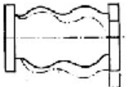
Desplazamiento lateral / Lateral displacement
