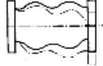
Desplazamiento lateral / Lateral displacement
